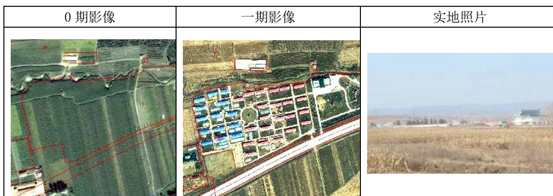
图示 2：某处大遗址新建住宅小区的两期影像对比与实地照片
