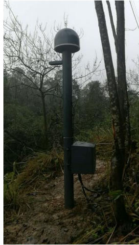
图 3-13 GPS 监测宝顶山大佛湾岩体整体稳定性
