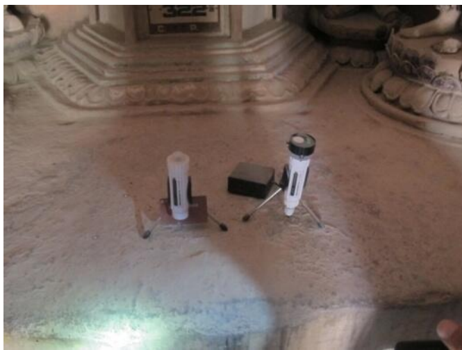
图 4-1 洞窟内温湿度及二氧化碳传感器
